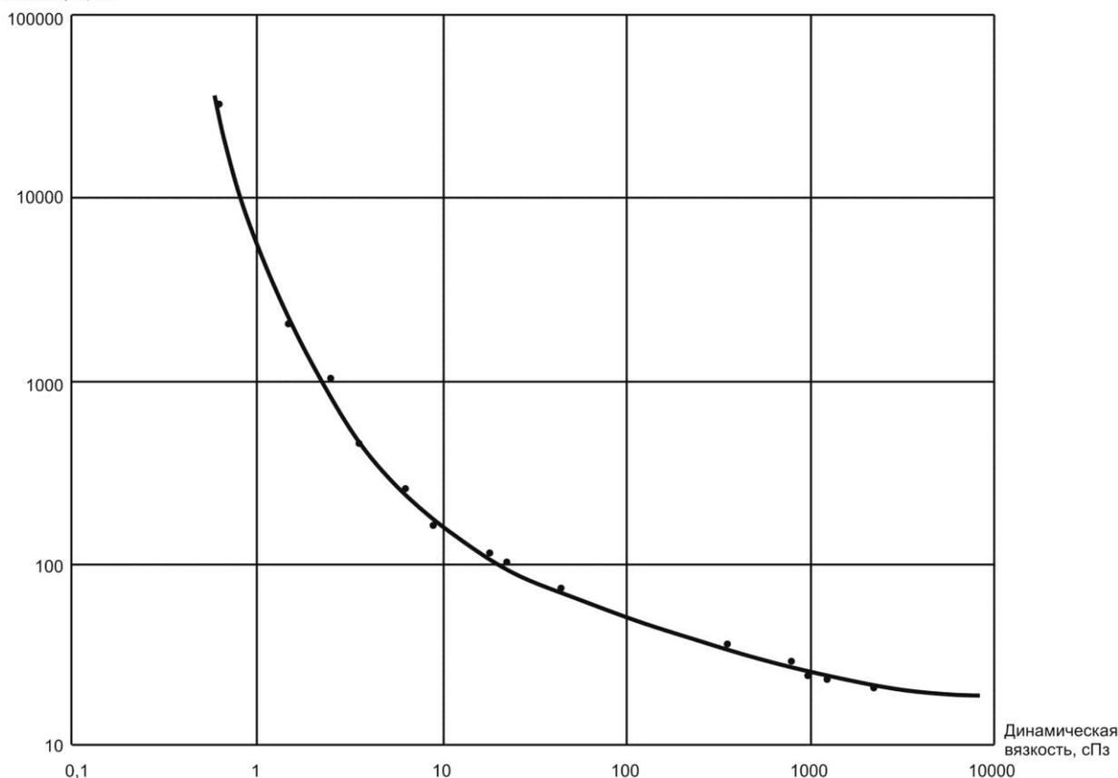
Рис. Градуировочный график для оценки динамической вязкости углеводородов методом ЯМР-анализа
