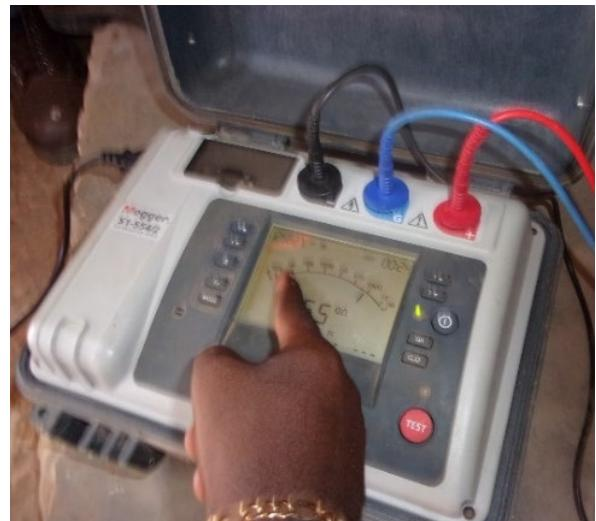
Рис. 13. Мегаомметр
