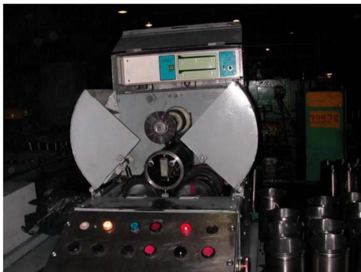
Рис. Процесс дефектовки гильзы блока цилиндров дефектоскопом НТ-8
