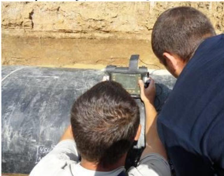
Рис. 1. Исследование дефекта царапина на поверхности стальной трубы с помощью электронной аппаратуры
