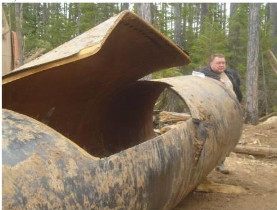
Рис. 5. Вид сбоку разрыва трубы
