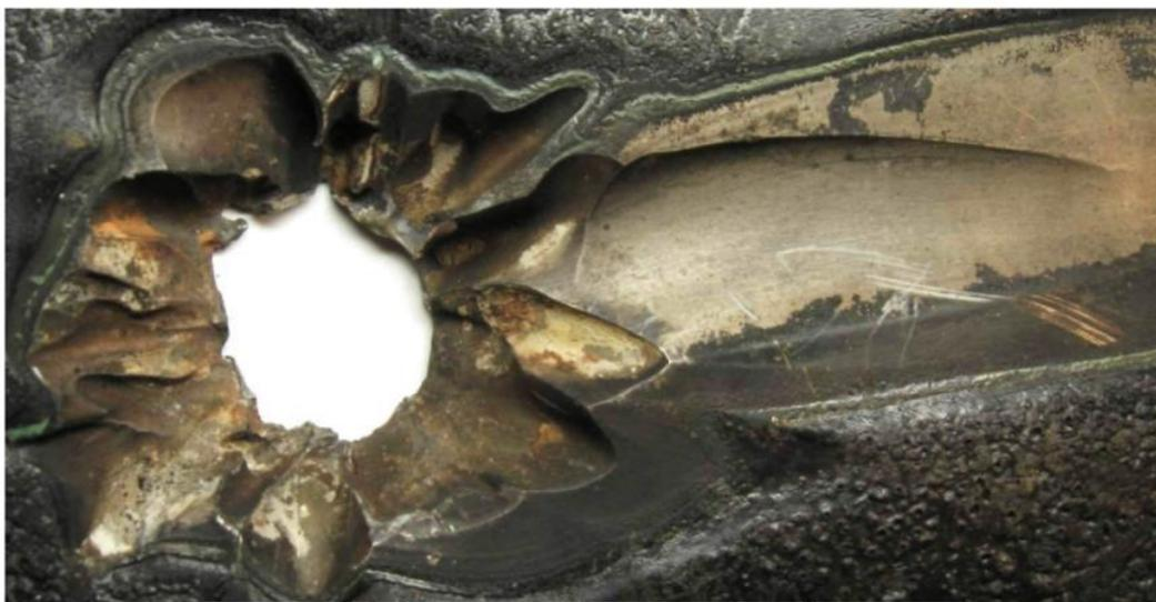
Рис. 2. Дефект вкатанный металл разорванной трубы
