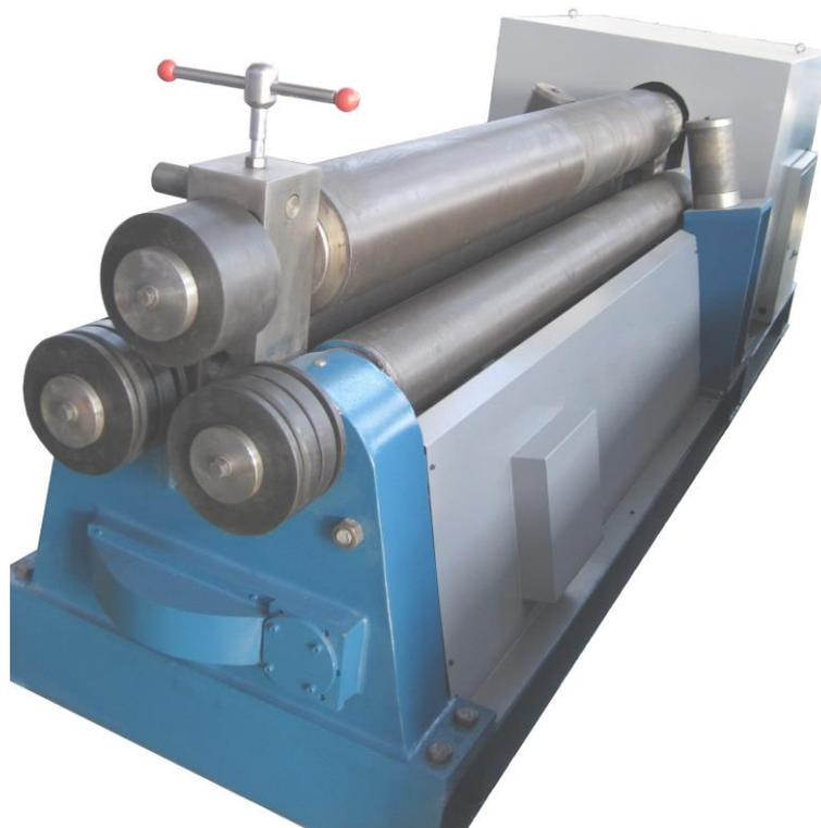
Рис. 1. Вальцы листогибочные трехвалковые с гидравлическим приводом
