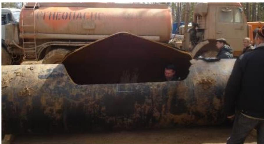
Рис. 4. Вид разрыва трубы после гидроиспытаний на трассе
