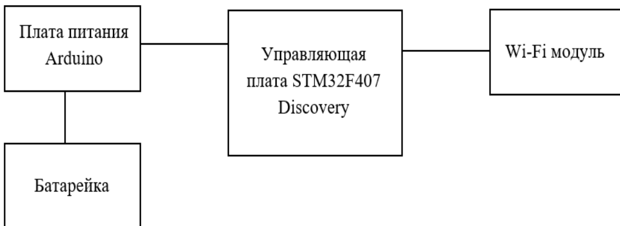
Рис. 5. Структурная схема перчатки управления
