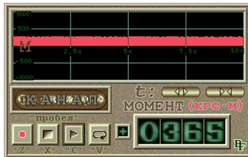
Рис. 3. Осциллограмма крутящего момента при осевой нагрузке 120 кН
