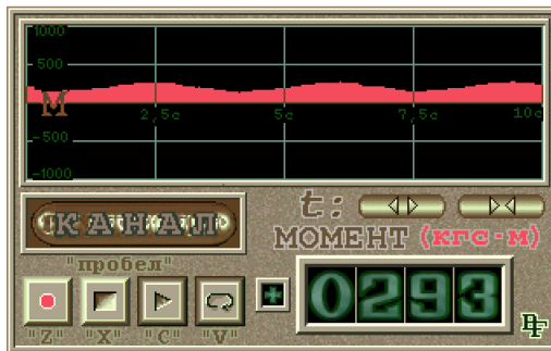
Рис. 4. Осциллограмма крутящего момента при осевой нагрузке 160 кН
