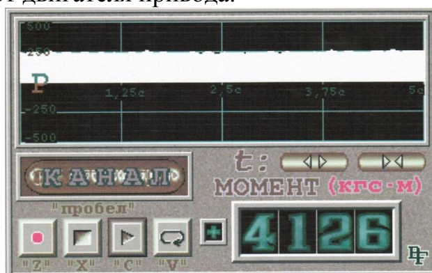
Рис. 1. Оциллограмма мощности при осевой нагрузке 120кН
