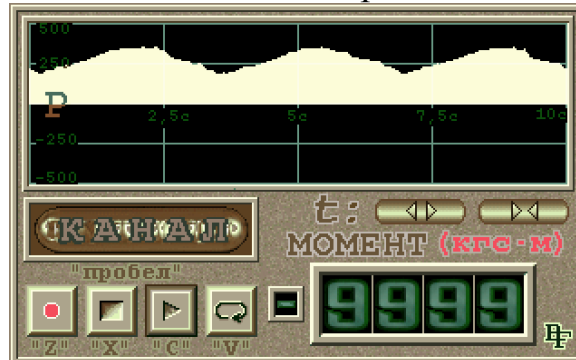
Рис. 2. Осциллограмма мощности при осевой нагрузке 160кН
