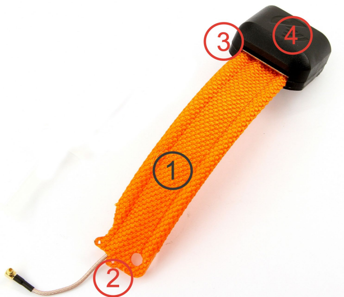
Рис. 6. Модернизированная GPS/ГЛОНАСС антенна gFixer
