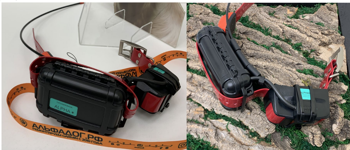
Рис. 2. Внешний вид модернизированного ошейника Garmin T5
