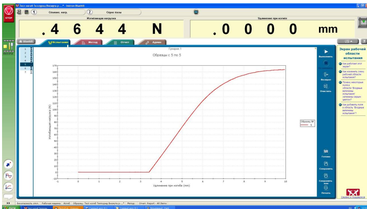
Рис. 1. Результаты испытания на изгиб стального образца
