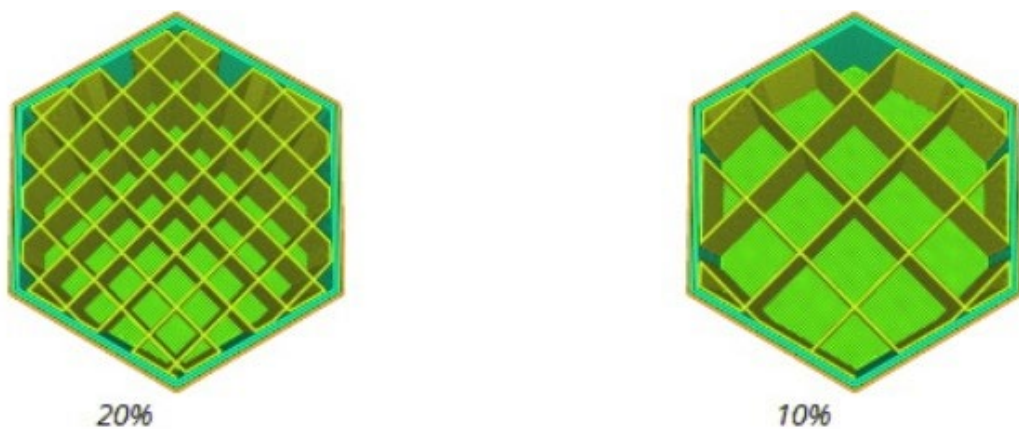
Рис. 1. Пример заполнения детали при 10% и 20%
