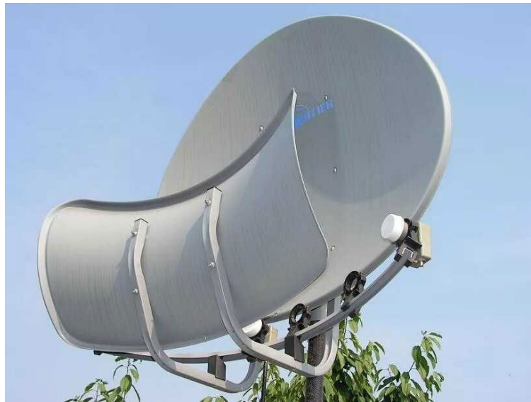
Рис. 3. Тороидальная спутниковая антенна
