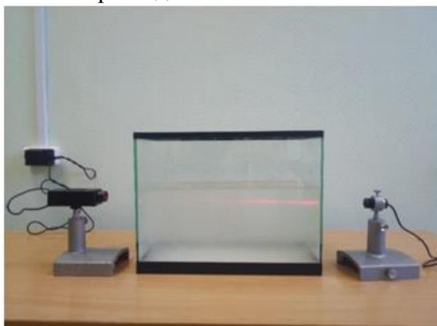
Рис. 1. Установка: фотоприемник, лазер, аквариум, исследуемая среда
