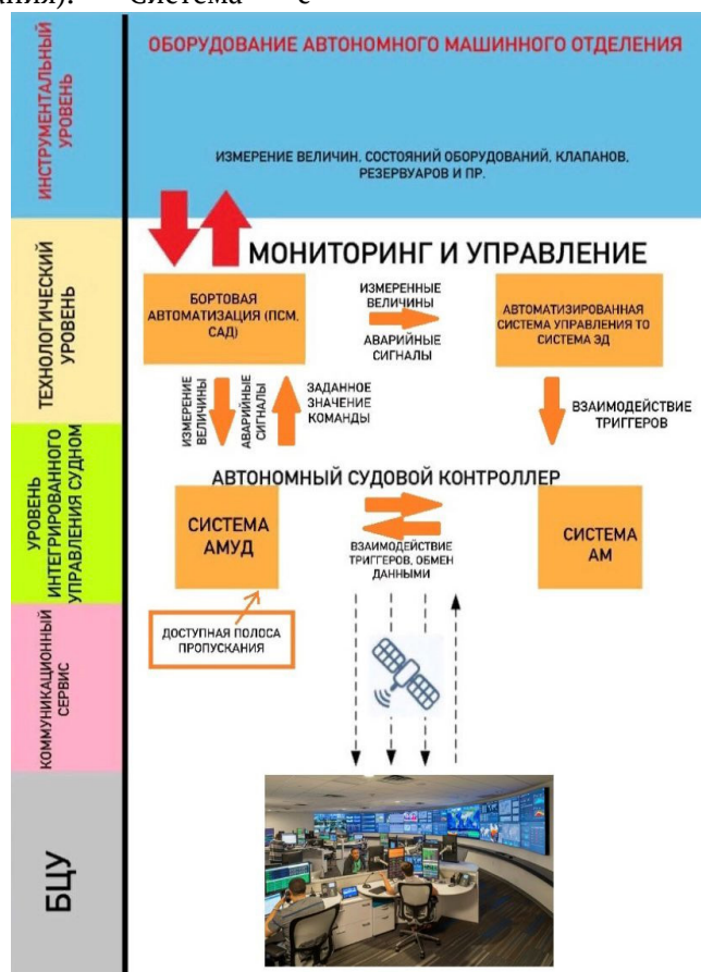
Рис. Структурное расположение АЕМС (АМУД) проекта «MUNIN»
