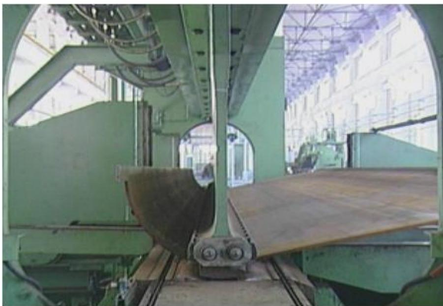
Рис. 1. Формовка левой части заготовки на трубоформовочном прессе
