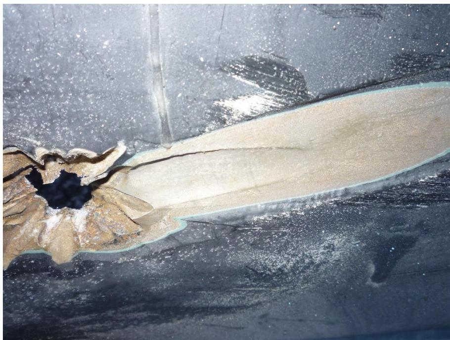
Рис. 2. Дефект вкатанный пригар разорванной трубы
