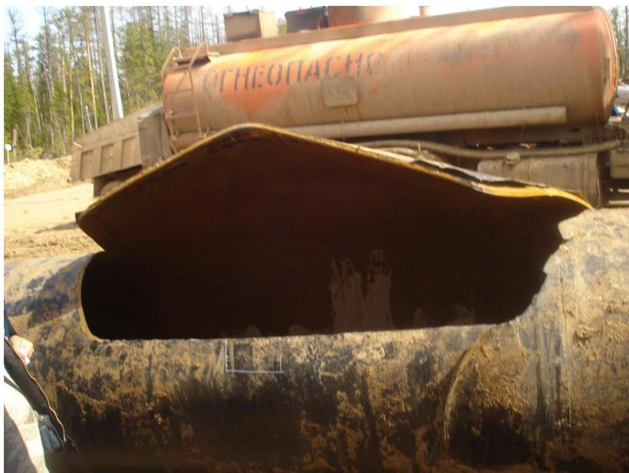
Рис. 1. Разрыв трубы после гидроиспытаний при непроваре сварного шва
