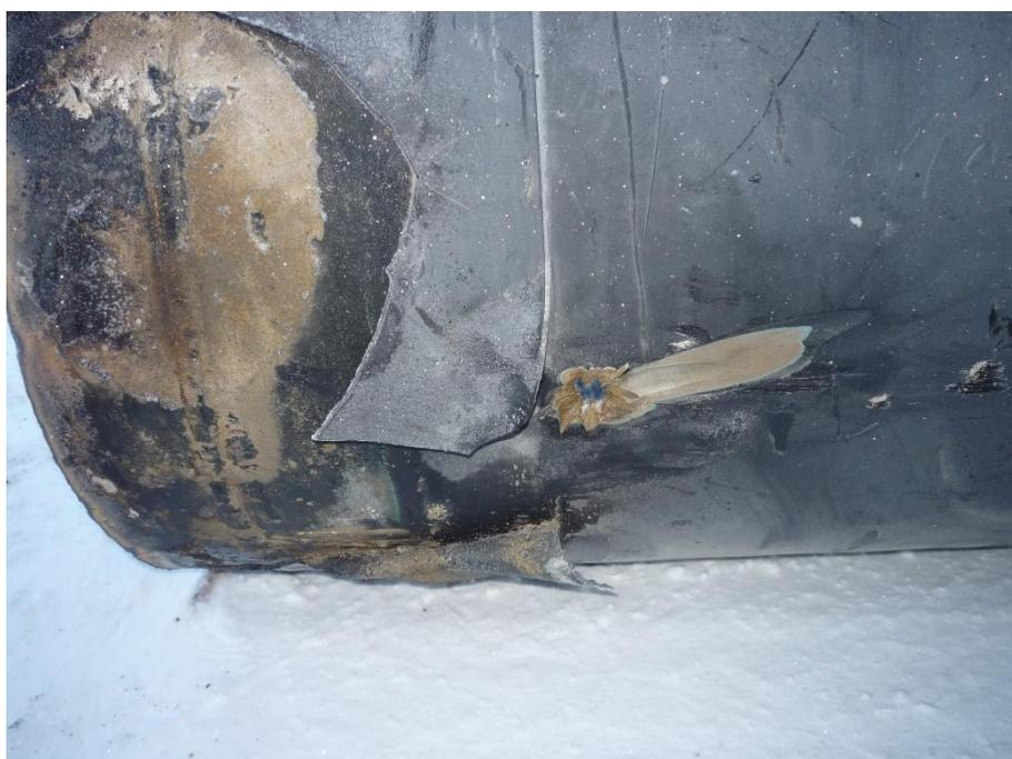
Рис. 1. Дефект вкатанный пригар на внешней поверхности трубы
