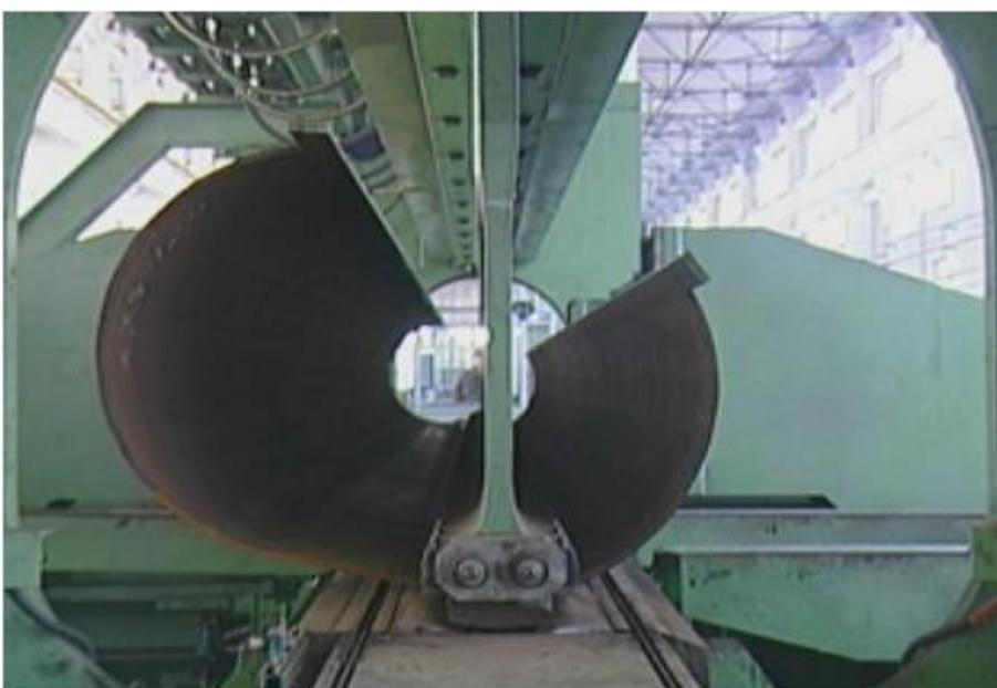
Рис. 2. Формовка правой части заготовки на трубоформовочном прессе
