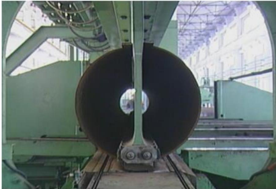
Рис. 3. Формовка центральной части заготовки на трубоформовочном прессе
