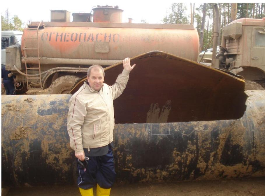
Рис. 3. Разрыв трубы
