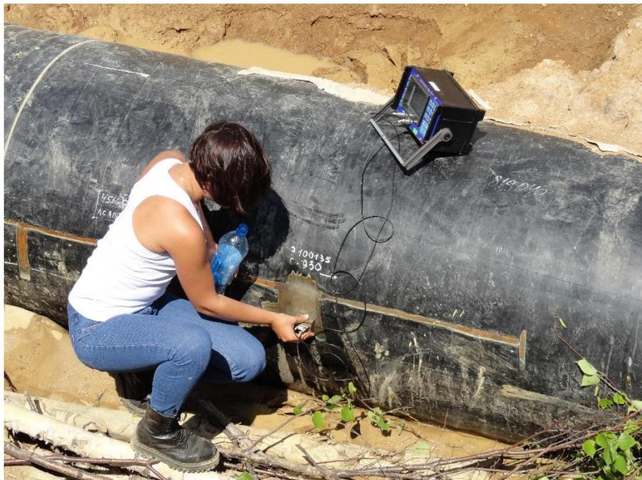
Рис. 1. Исследование дефекта риска на поверхности трубы с помощью аппаратуры
