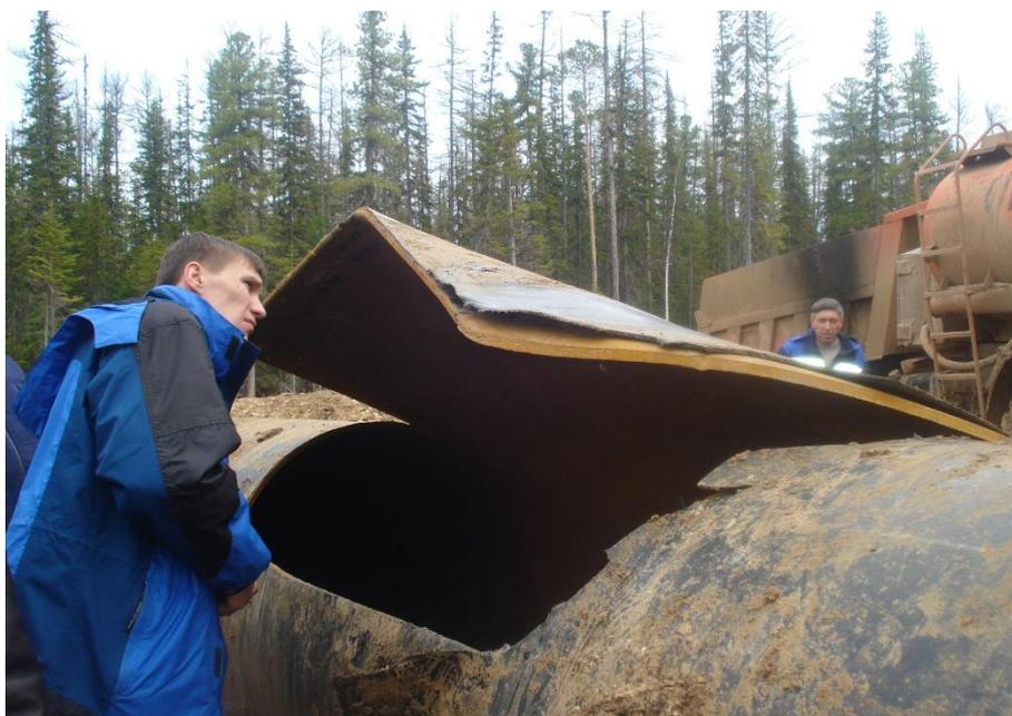
Рис. 2. Вид сбоку разрыва трубы
