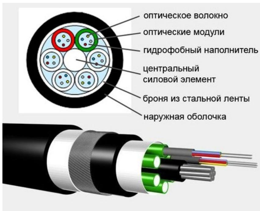
Рис. 2. Строение волоконно-оптического кабеля
