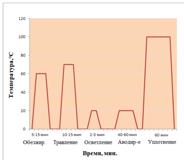
Рис. 2. Схема основных стадий процесса анодирования для алюминиевых сплавов
