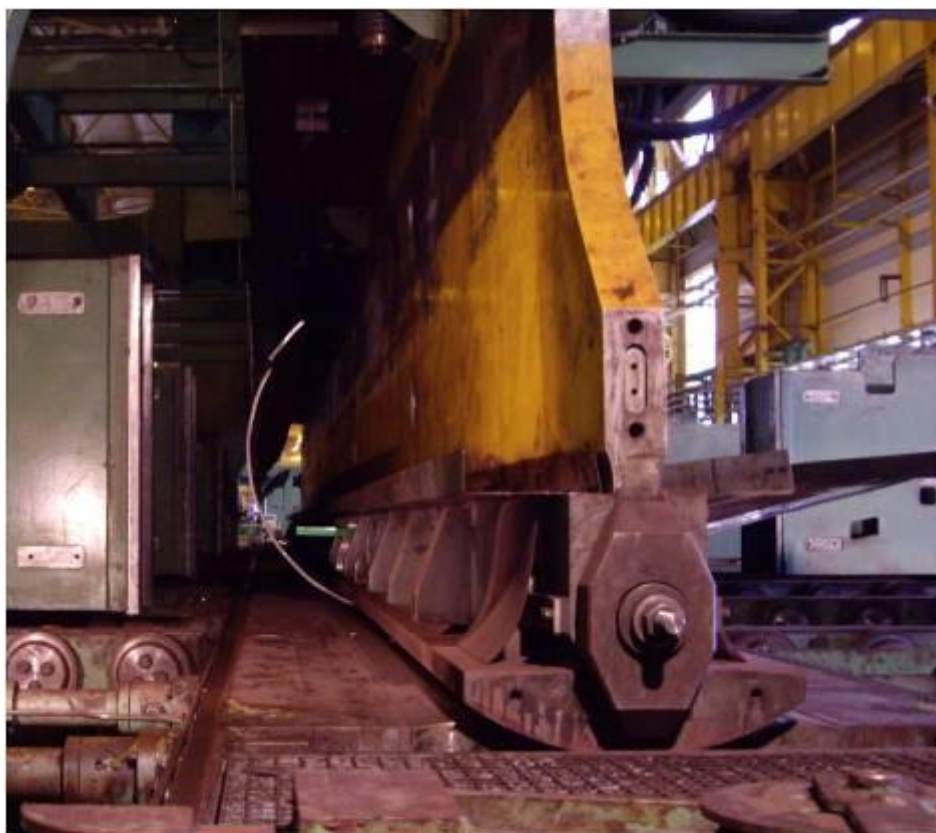
Рис. 2. Формовка частично изогнутой заготовки на прессе
