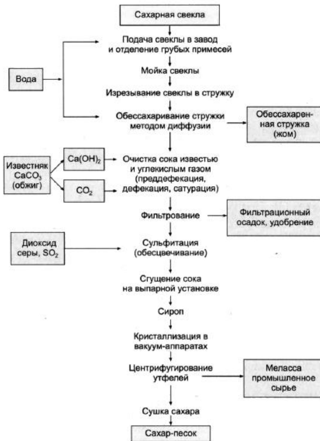
Рис. Принципиальная схема производства сахара
