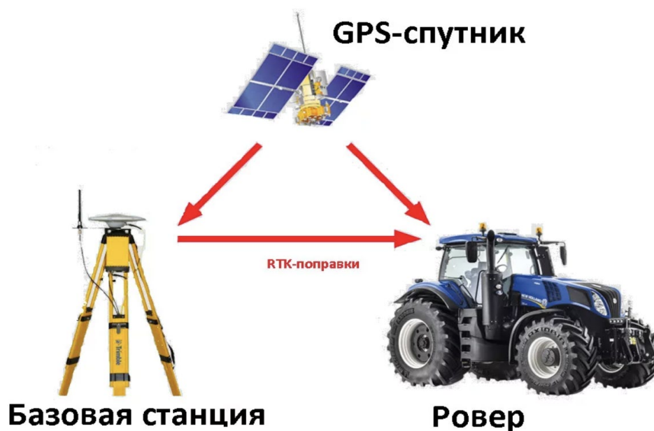
Рис. 2. Принцип взаимодействия GPS-спутника, базовой станции и ровера
