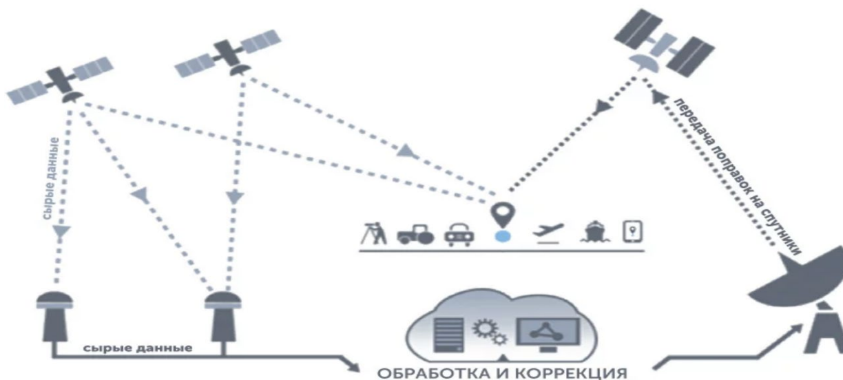
Рис. 3. Принципы взаимодействия элементов в рамках системы дифференциальной коррекции
