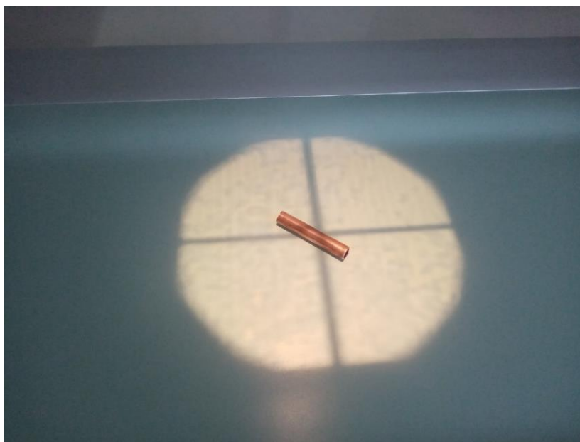
Рис. 4. Пример расположения медного образца на столе рентгена
