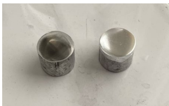
Рис. 6. Два микрошлифа: непротравленный (слева) и протравленный (справа)
