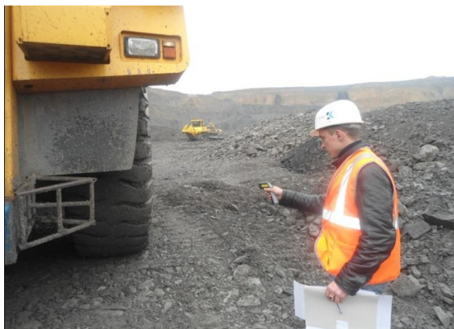
Рис. 2. Замер температуры пневматических шин автосамосвала БелАЗ-75131 пирометром Raytek-MT6
