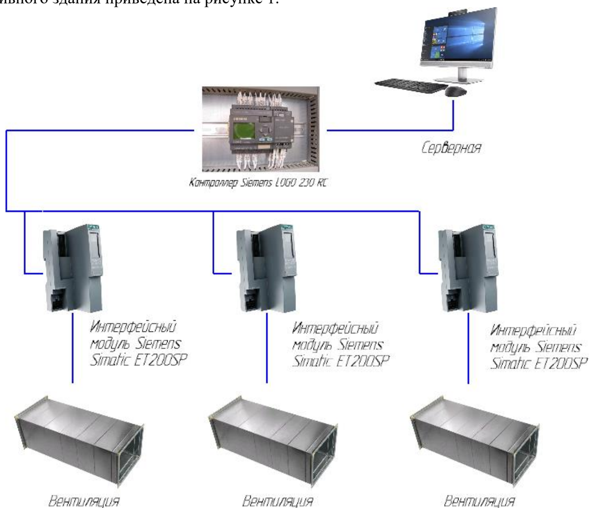
Рис. 1. Структурная схема автоматизированной системы вентиляции административного здания
