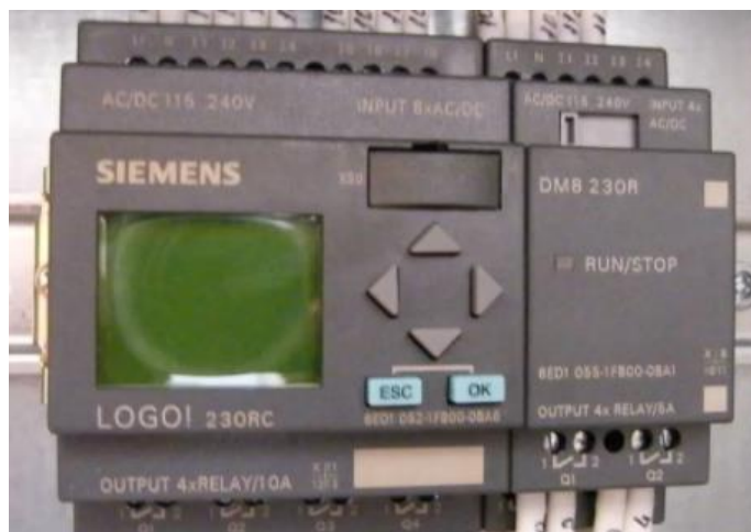
Рис. 2. Контроллер Siemens LOGO 230 RC
