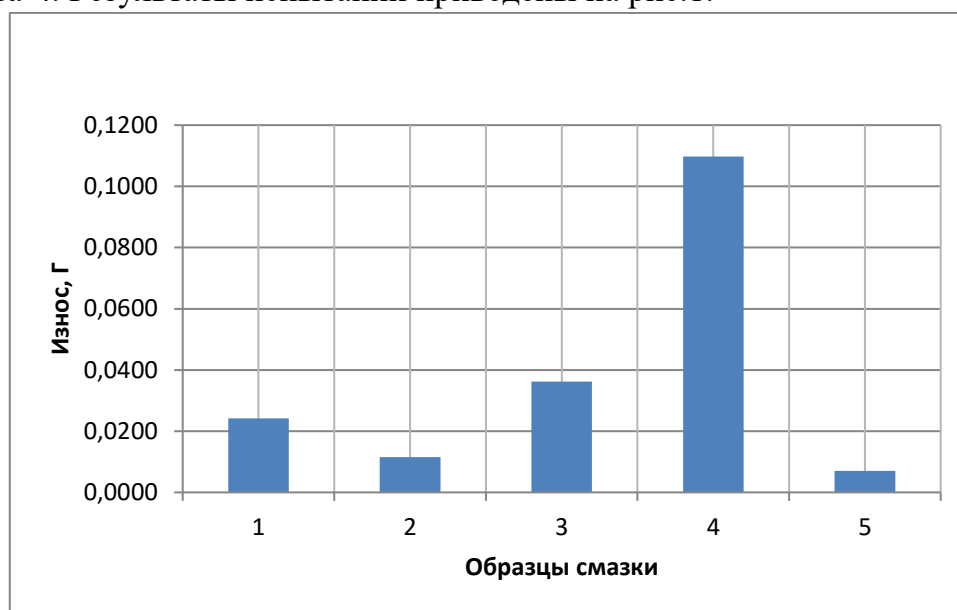
Рис. 1. Диаграмма результатов испытания на износ при смазке: 1 – ПУМА осн., 2 – ПУМА МО, 3 – ПУМА В, 4 – МС-27, 5 – Вамива-4
