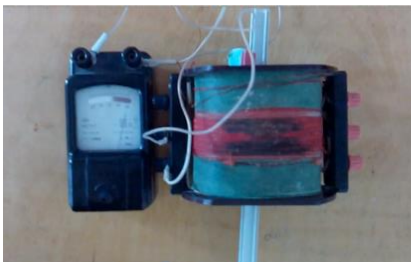
Рис. 5. Наличие тока индукции в катушке при «выстреле» магнитной пушки
