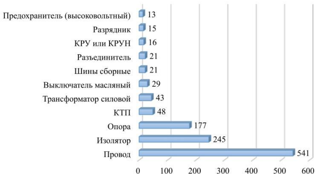
Рис. 3. Распределение технологических нарушений по видам повреждаемого оборудования за 2014 год
