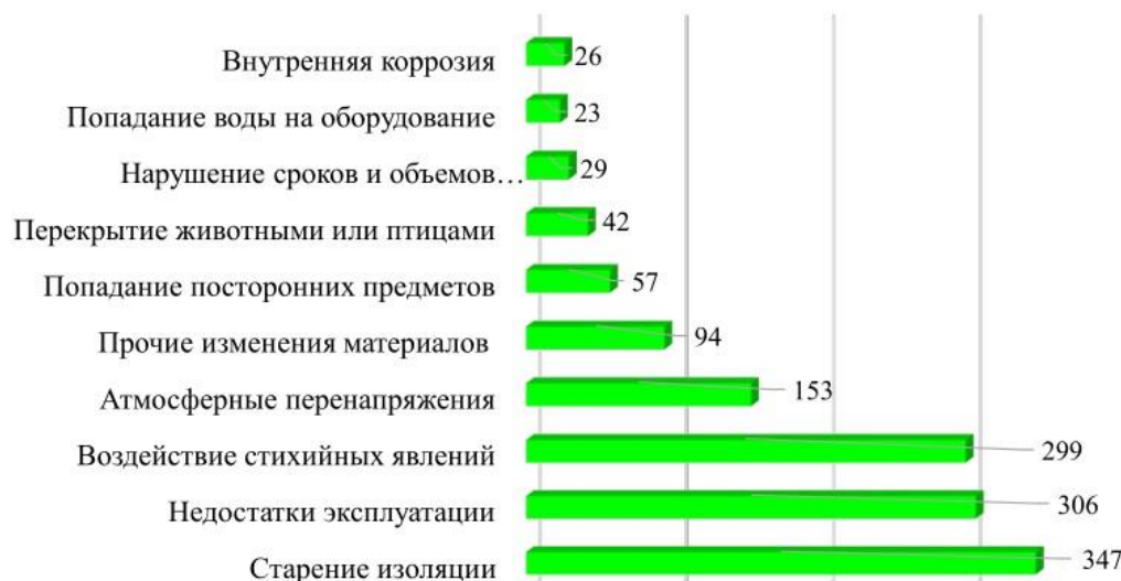
Рис. 2. Распределение причин нарушений, происшедших в 2014 году в электрических сетях Кубани напряжением 6-10 кВ
