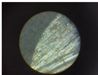
Рис. 3. Образец нержавеющей стали марки 12x18n12т после воздействия водного раствора хлорида натрия (3%)
