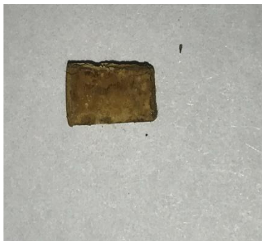
Рис. 3. Образец стали СТЗСП в дистиллированной воде
