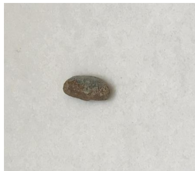
Рис. 4. Образец стали СТЗСП в водном растворе щавелевой кислоты (3 %)
