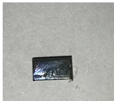
Рис. 2. Образец стали СТЗСП в водном растворе карбоната натрия (3 %)
