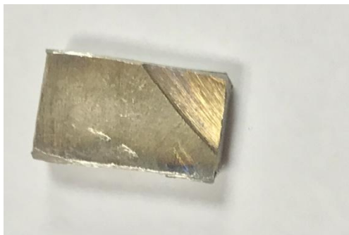
Рис. 1. Образец нержавеющей стали марки 12X18H12T
