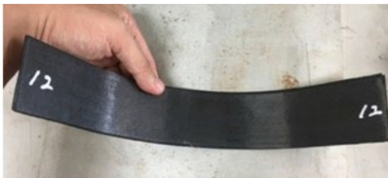
Рис. 3. Элемент шасси БПЛА из углепластика [4]
