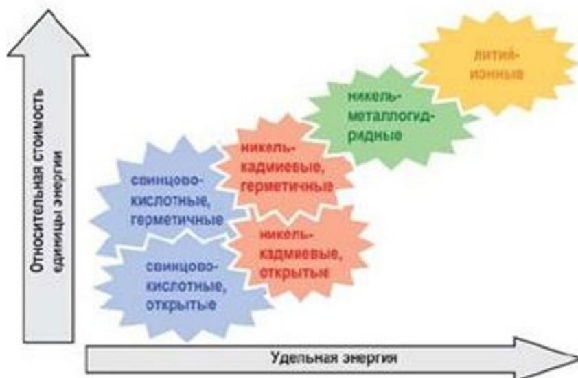
Рис. Соотношение стоимости и энергетических параметров для АКБ различных электрохимических систем [3]
