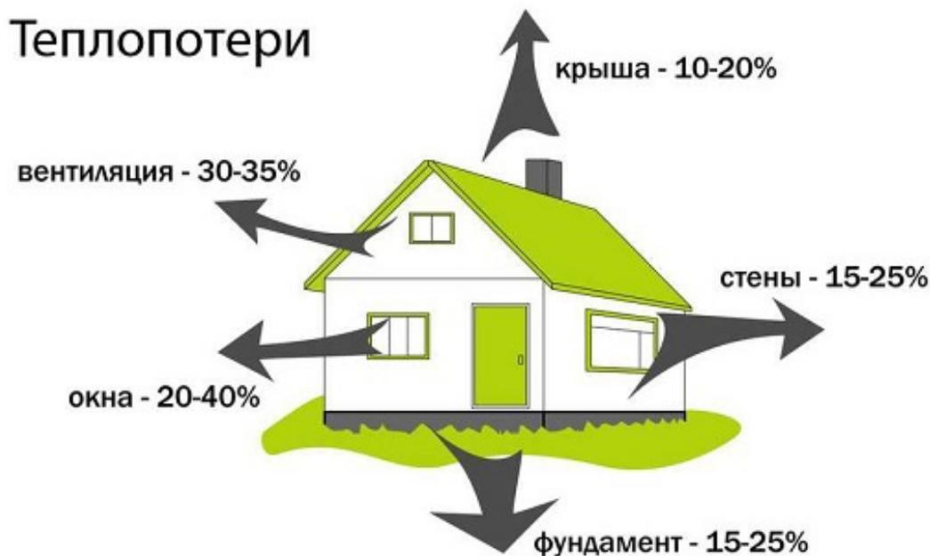
Рис. Процент теплопотерь здания
