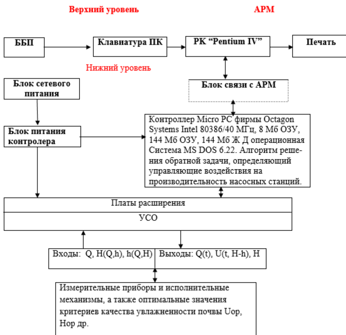
Рис. Технологическая схема макета системы поддержания УГВ ПС
