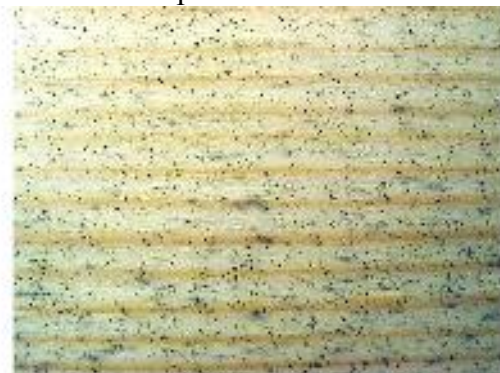
Рис. 6. Образец необработанной полиуретановым лаком древесины после испытания на грибостойкость
