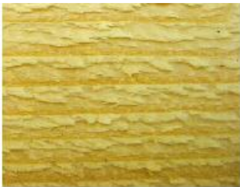
Рис. 5. Образец обработанной полиуретановым лаком древесины, после испытания на грибостойкость
