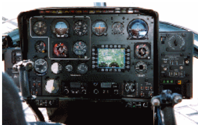
Рис. 2. Приборная доска модернизированного вертолѐта Ми-2
