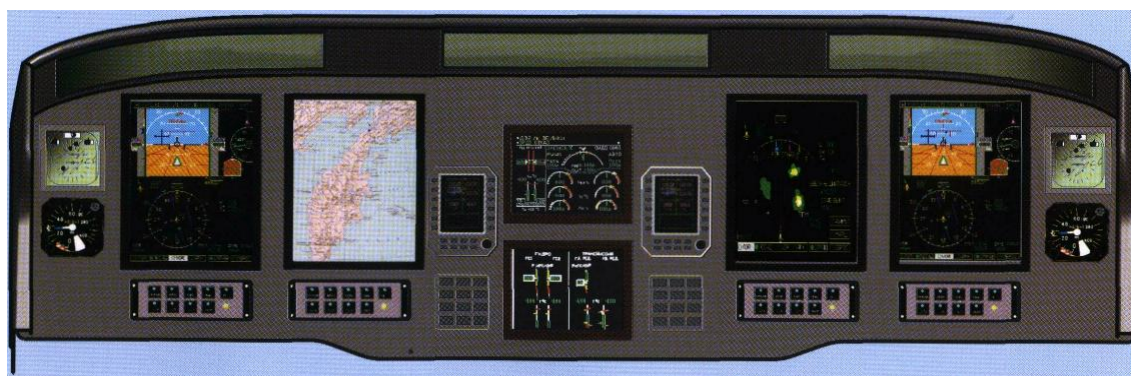
Рис. 4. Один из вариантов компоновки приборной доски вертолѣта Ми-38
