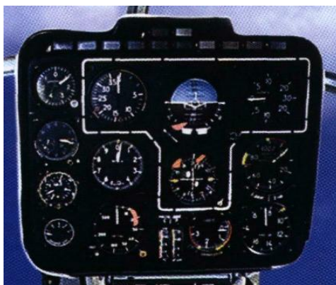
Рис. 1. Традиционная приборная доска вертолѐта Ми-2
