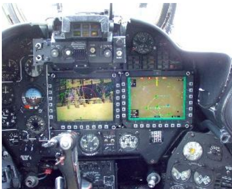
Рис. 3. Приборная доска вертолѣта Ми-35
