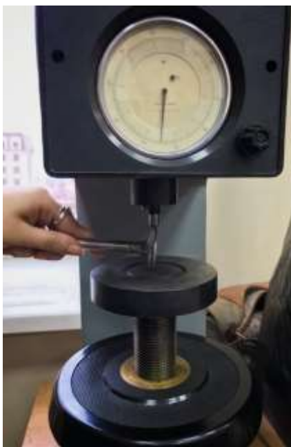
Рис. 5. Измерение твердости на «ТР5006М»
