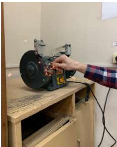
Рис. 3. Искры на настольном заточном станке «Packard Spence PSBG – 250А»
