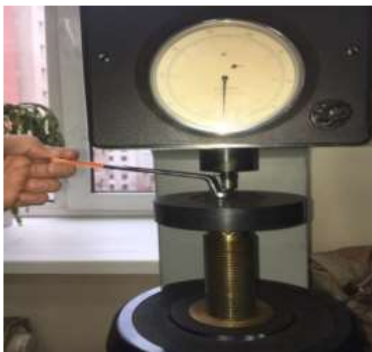
Рис. 2. Измерение твёрдости по методу Роквелла
