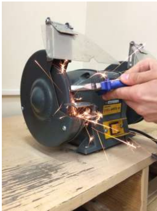
Рис. 2. Проба на искру образца №3
