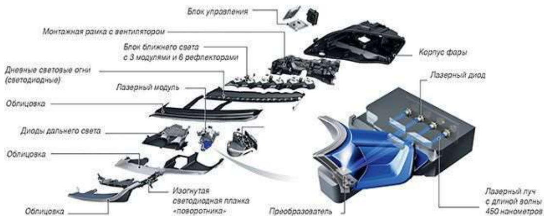
Рис. 3. Устройство лазерной фары
