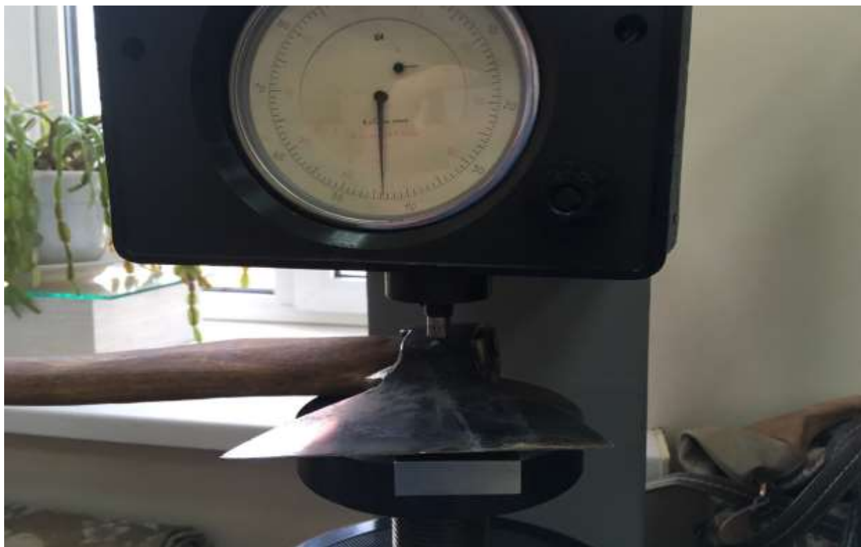
Рис. Замер твёрдости на «ТР5006М»
