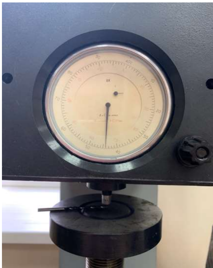
Рис. 2. Замер твёрдости по методу Роквелла на «ТР5006М»
