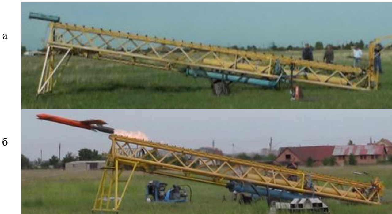
Рис. 3. Испытания пневматического НПУ Р12П: а – бросок груза-макета; б – запуск реактивного БЛА РМ130У
