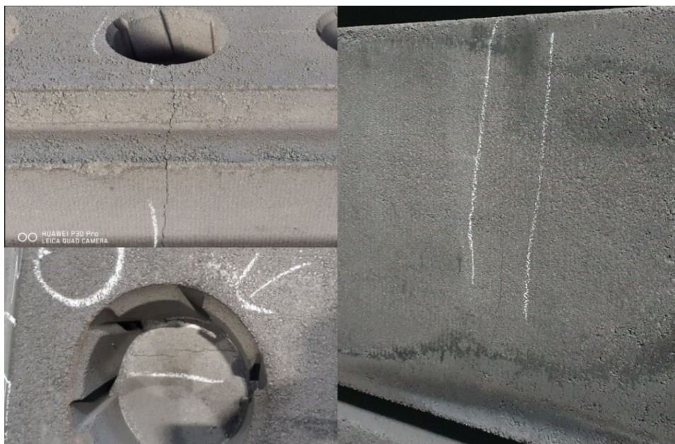
Рис. 2. Образование вертикальных трещин и трещин в ниппельных гнездах анодов
