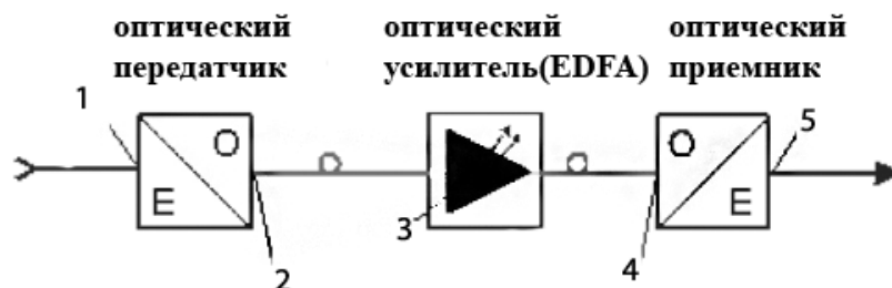
Рис. 1. Структурная схема простейшей аналоговой ВОЛС, где: 1 – U_{\text{вх}}(C/N_{\text{вх}})/C/N_m ; 2 – P_{\text{вых}}/C/N_{\text{вых}} ; 3 – P_{\text{вх}}/C/N_{\text{EDFA}} ; 4 – P_{\text{вх}}/C/N_R ; 5 – P_{\text{вых}}/C/N_{\Sigma}
