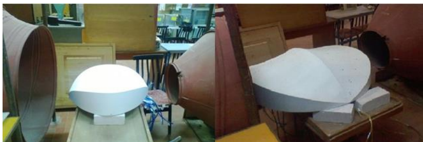
Рис. 1 Макеты криволинейных сооружений, установленные в аэродинамической трубе
