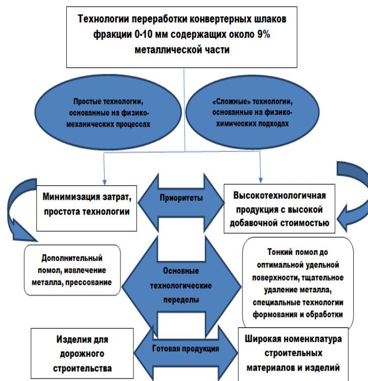
Рис. 2. Схема переработки конвертерного шлака
