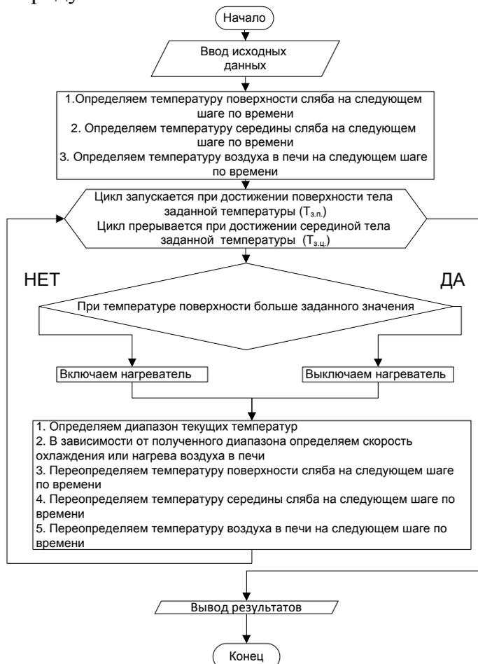
Рис. 3. Алгоритм управления нагрева материалов в печи
