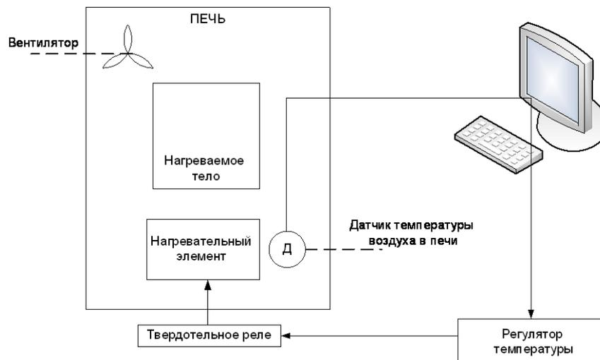
Рис. 4. Предлагаемая модернизированная структурная схема автоматического управления электрической конвективной печи для гомогенизации алюминиевых слябов
