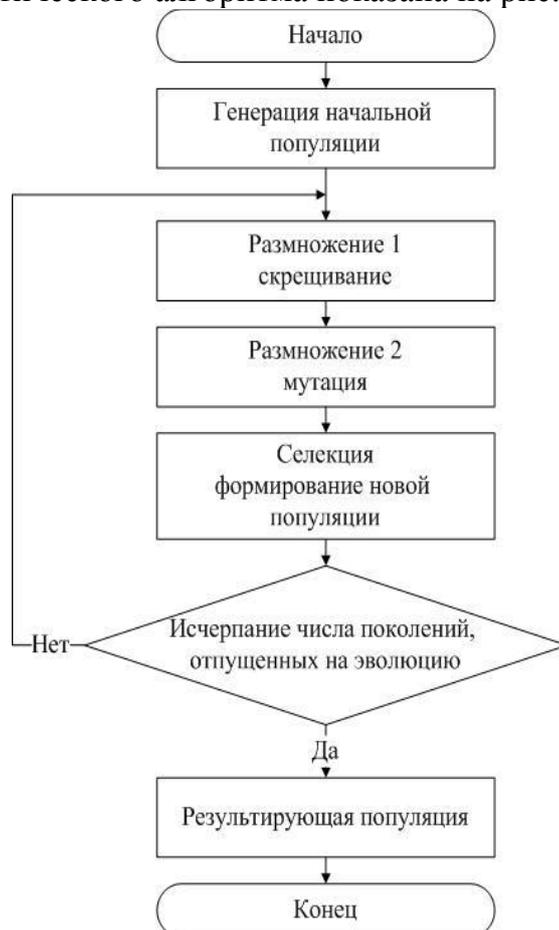
Рис. 1. Блок-схема генетического алгоритма
