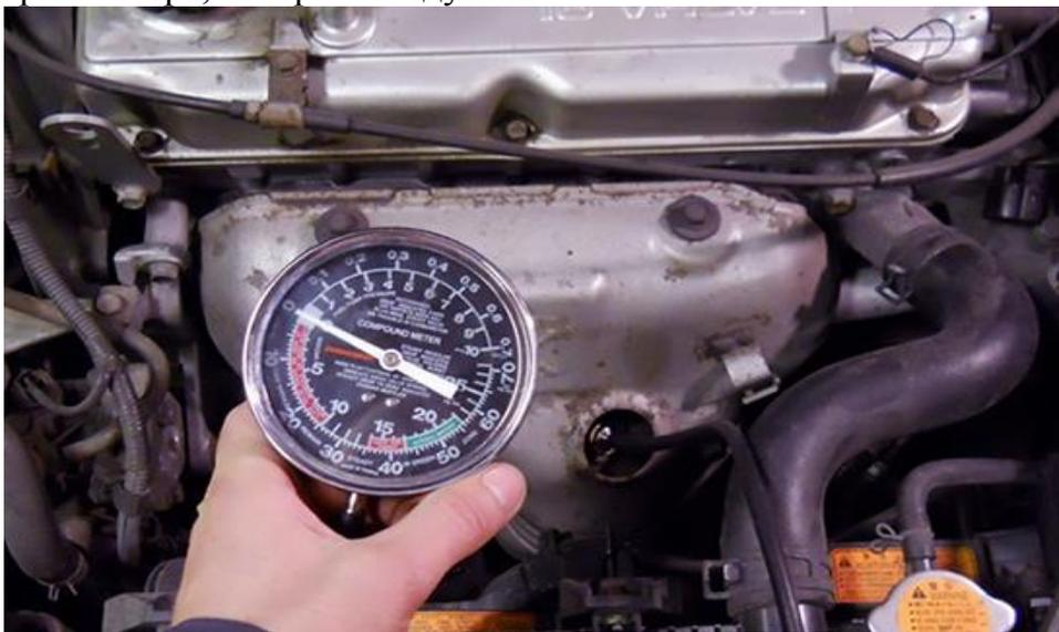
Рис. 3. Измерение давления в выпускной системе
