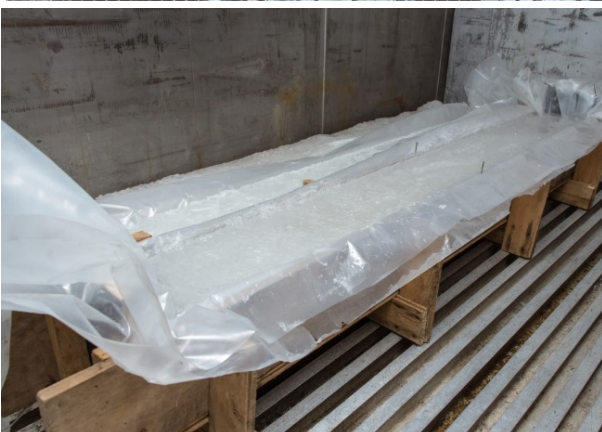
Рис. 7. Процесс изготовления образцов льда
