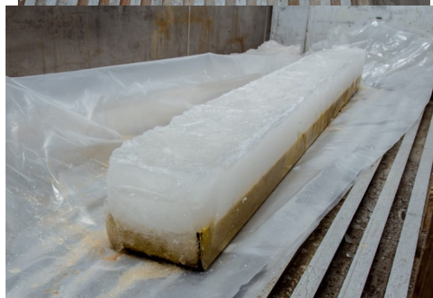
Рис. 7. Процесс изготовления образцов льда
