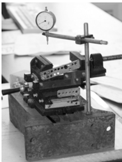
Рис. 8. Установка для измерения поверхности образца
