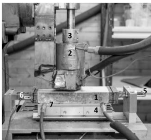
Рис. 1. Экспериментальная установка для испытаний бетона; 1 – образец бетона; 2 – держатель льда; 3 – поршень; 4 – линейная скользящая система; 5 – регулировочные винты; 6 – горизонтальный тензодатчик; 7 – алюминиевая нагревательная пластина [6, с. 5]
