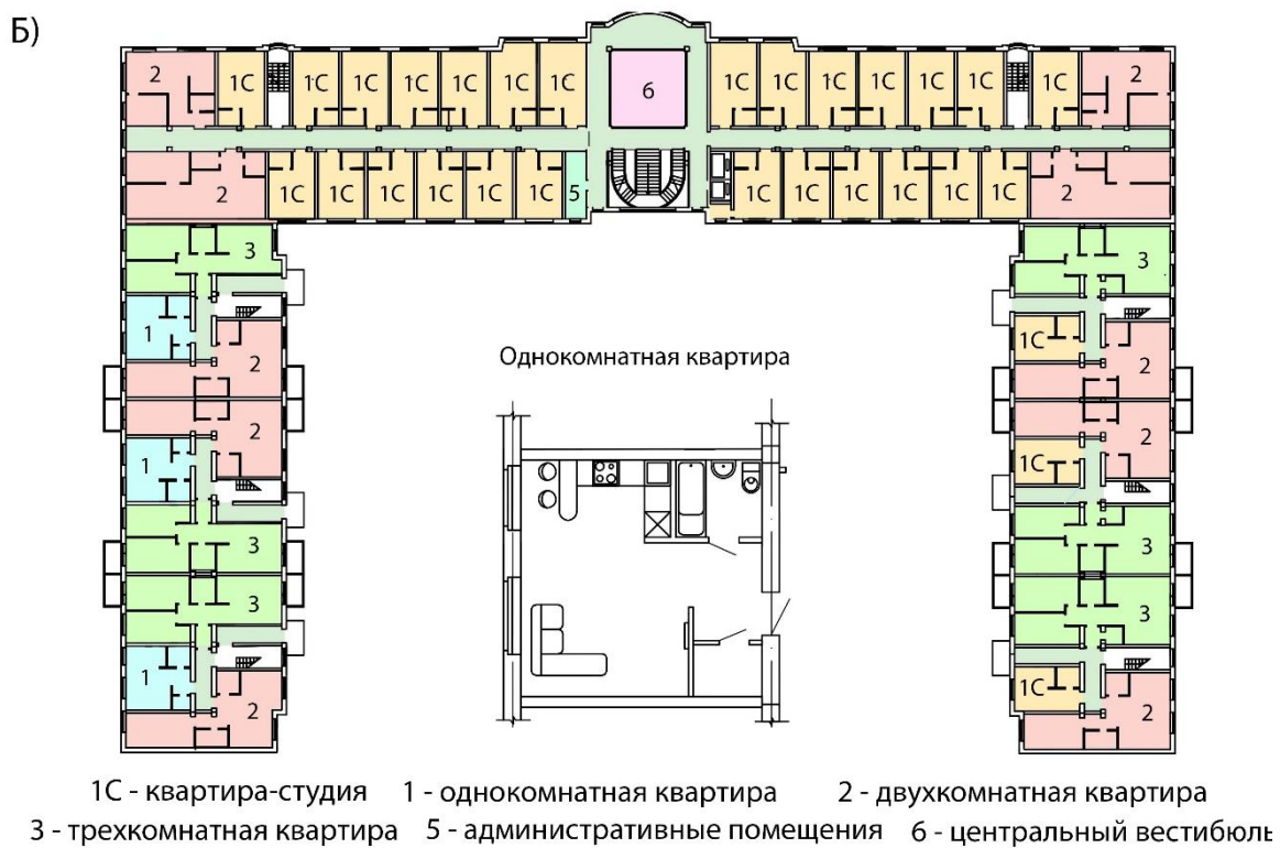
Рис. 3. Комплекс жилых домов из трех блоков А – план первого этажа, Б – план типового этажа
