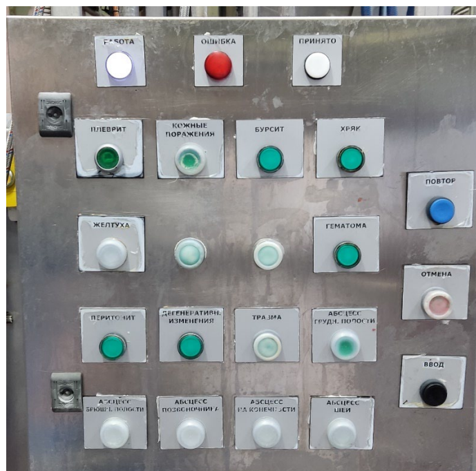
Рис. 7. Пульт регистрации диагнозов на позиции осмотра полутуш
