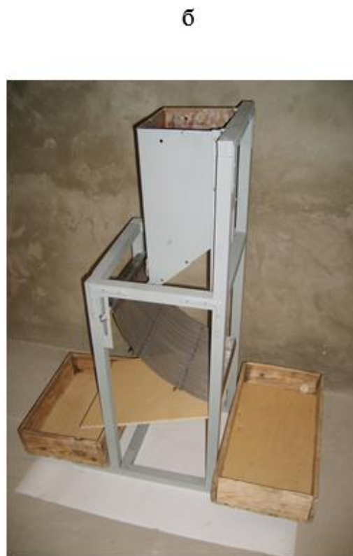
1 – рама; 2 – бункер; 3 – дозирующее устройство; 4 – сменный рабочий орган; 5 – скатная поверхность; 6 – шарнирное крепление рабочего органа; 7, 8 – семясборники.
