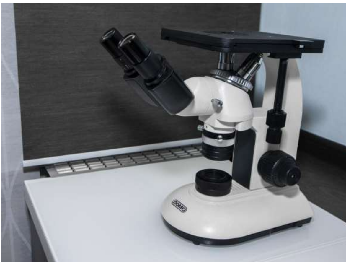
Рис. 3. Оптический металлографический микроскоп “МЕТАМ РВ-34”
