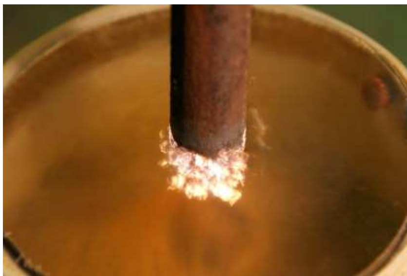
Рис. 3. Цементация металла в жидкой среде
