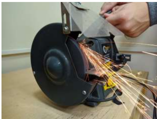
Рис. 3. Проба на искру
