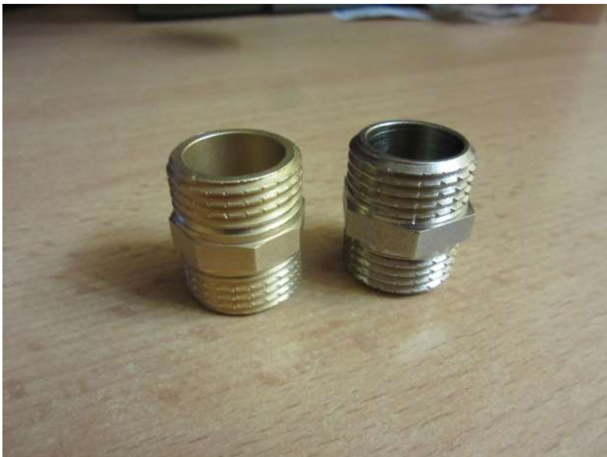
Рис. 1. Исследуемые образцы. Слева – образец из латуни, справа – образец из силумина
