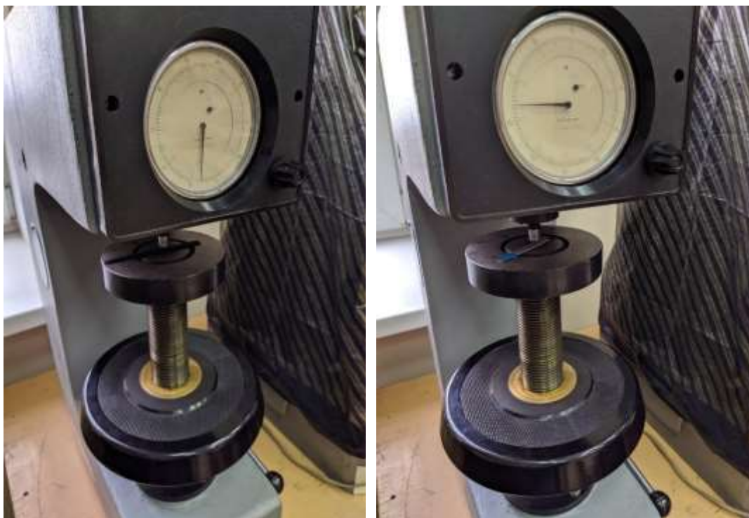
Рис. 3. Измерение твёрдости по методу Роквелла
