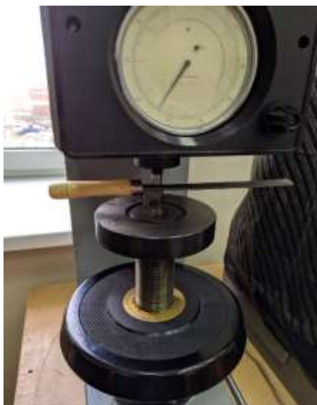
Рис. 2. Измерение твёрдости образцов по Роквеллу
