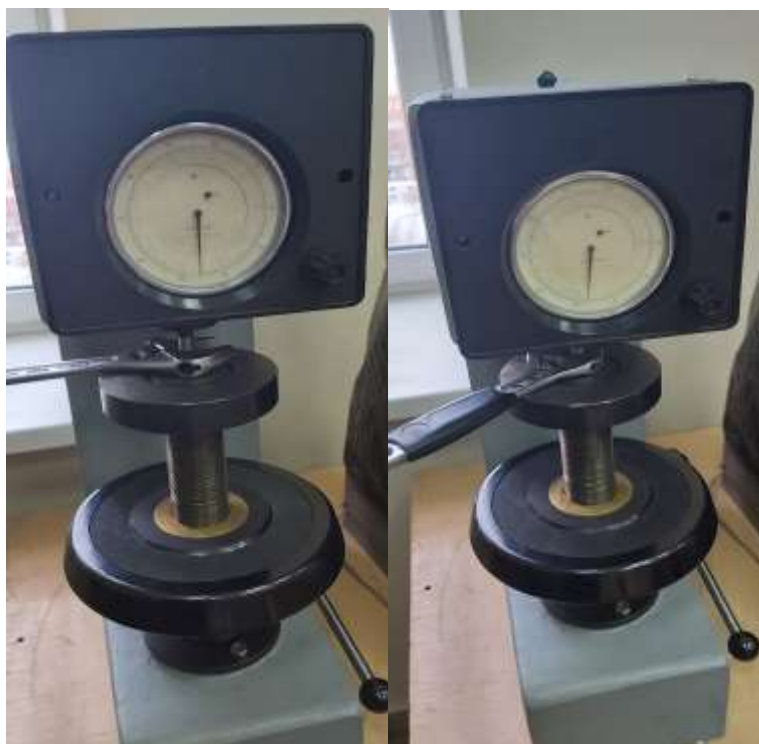
Рис. 2. Измерение твёрдости по методу Роквелла
