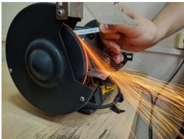
Рис. 5. Проба на искру образца №2
