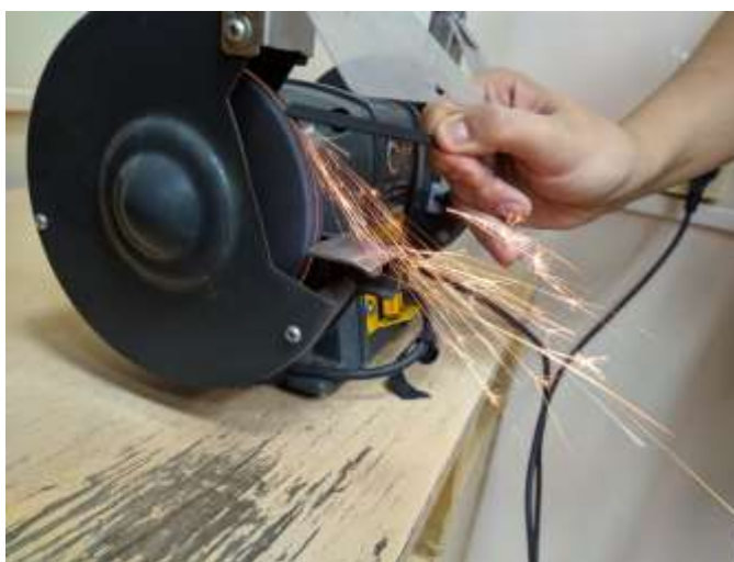
Рис. 4. Проба на искру образца №1
