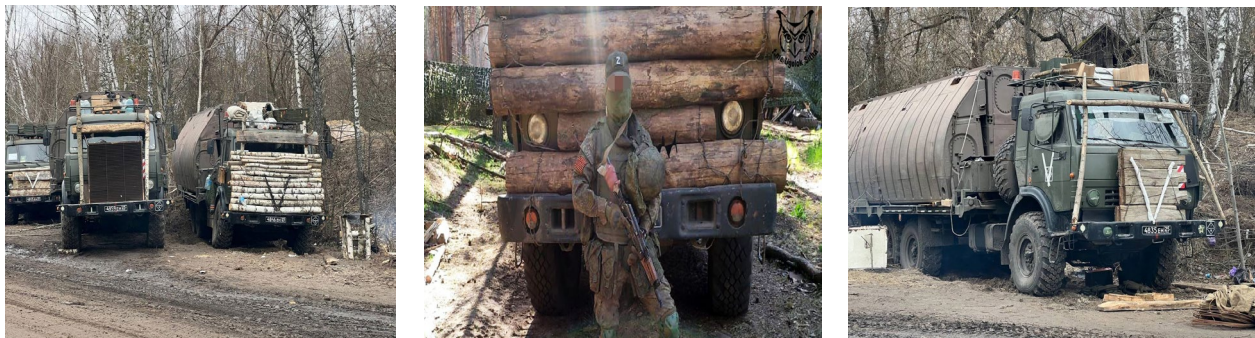
Рис. 2. Автомобили с самодельной защитой
