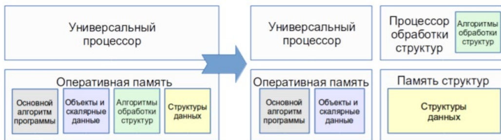
Рис. 2. Вычислительная система с аппаратной поддержкой операций над множествами и структурами данных
