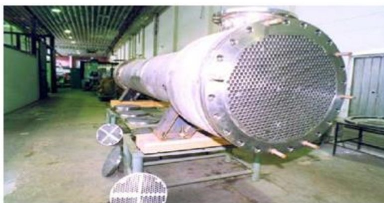
Рис. 2. Теплообменник с трубной системой из титанового сплава VT1-0
