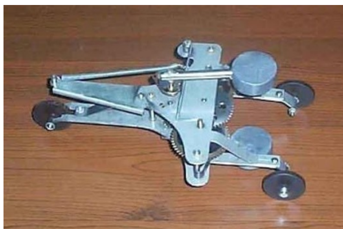
Рис. 1. Модель безопорного движителя В.Н. Толчина
