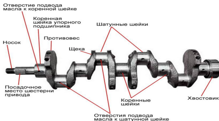
Рис. Конструкция коленчатого вала
