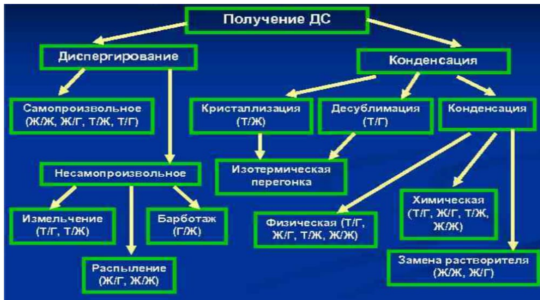
Рис. 3. Классификация способов получения дисперсных систем, где: Ж – жидкая фаза, Г – газообразная фаза, Т – твердая фаза [2]
