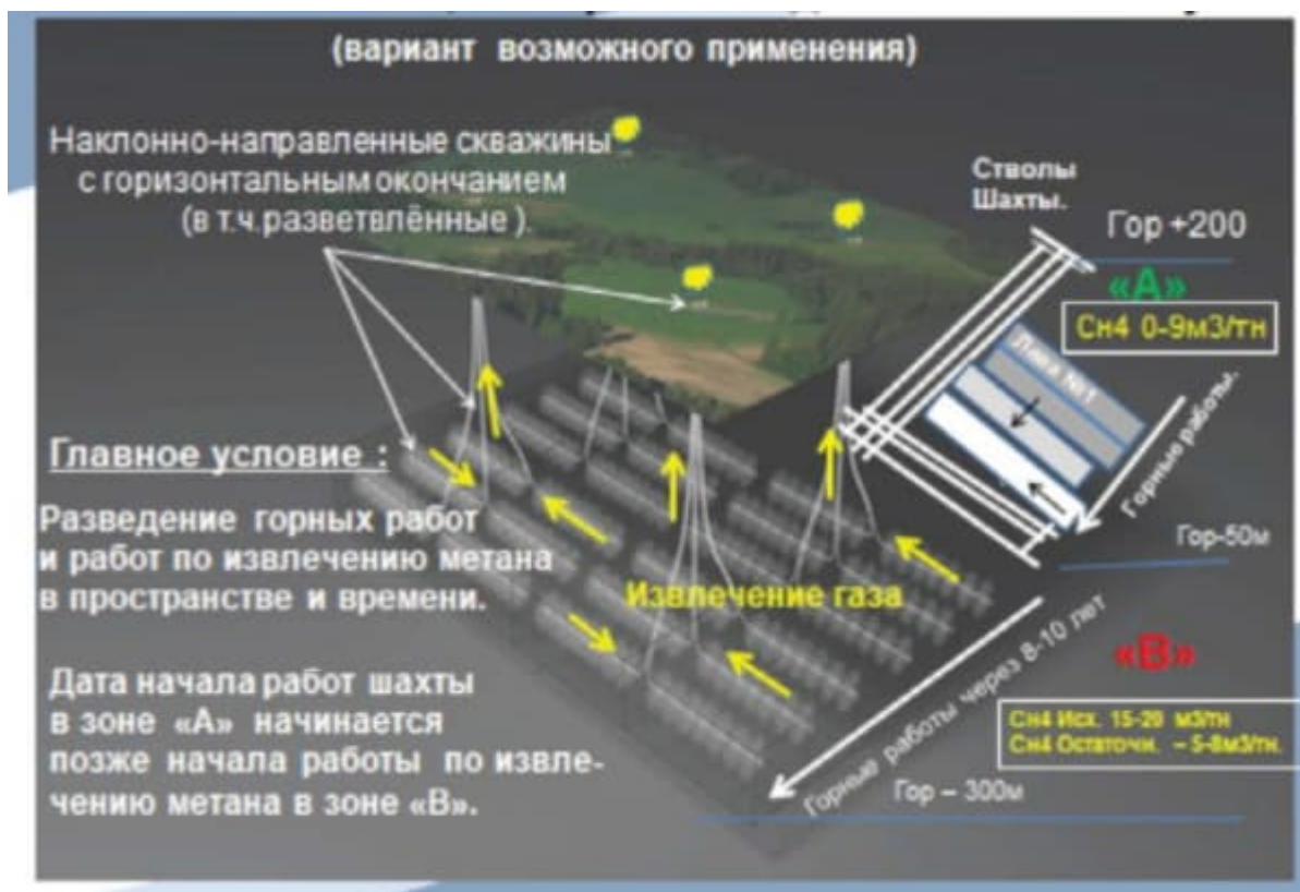
Рис. 5. Технология совмещения работ по добыче метана и угля [5]
