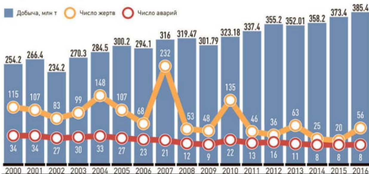
Рис. 3. Динамика объемов добычи угля, смертельного травматизма и аварийности на шахтах [4, 5]
