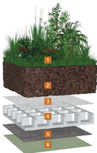
Рис. Конструкция зеленой кровли
