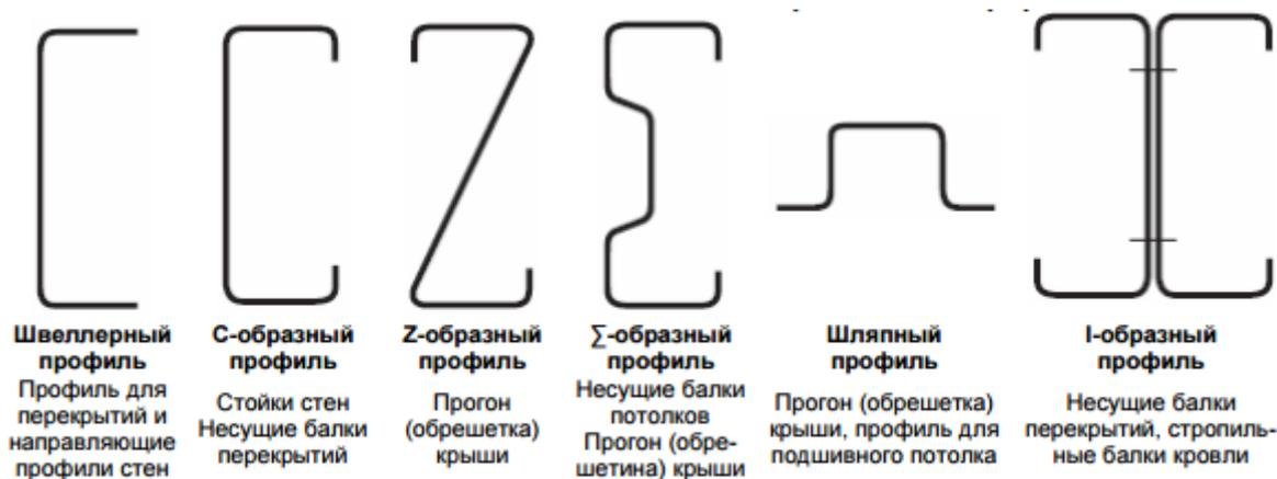
Рис. 1. Формы поперечного сечения профилей
