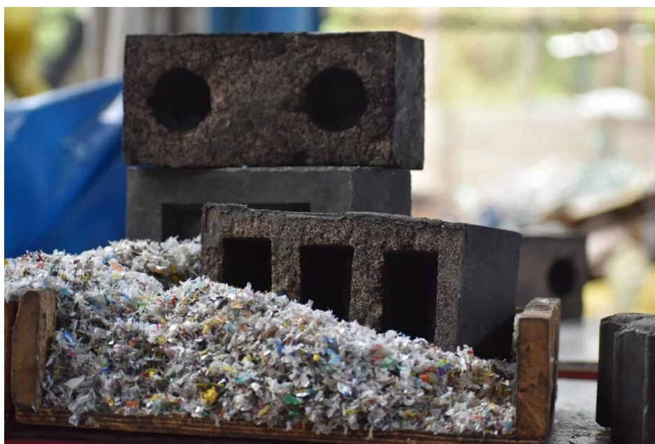
Рис. 2. Кирпич из переработанного пластика
