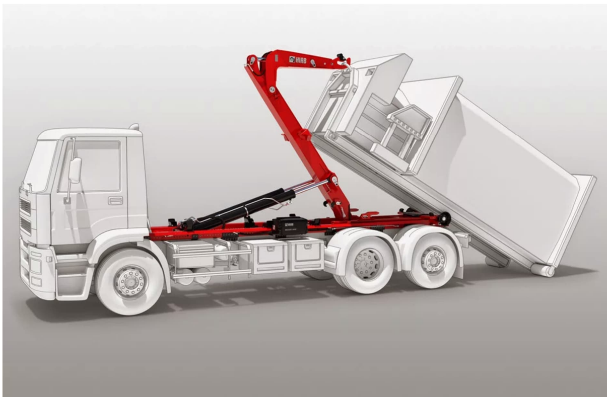
Рис. 4. Размещение системы мультилифт на автомобиле (крюковой захват Г-образной формы)
