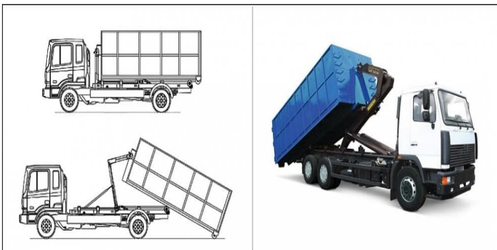
Рис. 1. Принцип работы системы мультилифт на автомобиле
