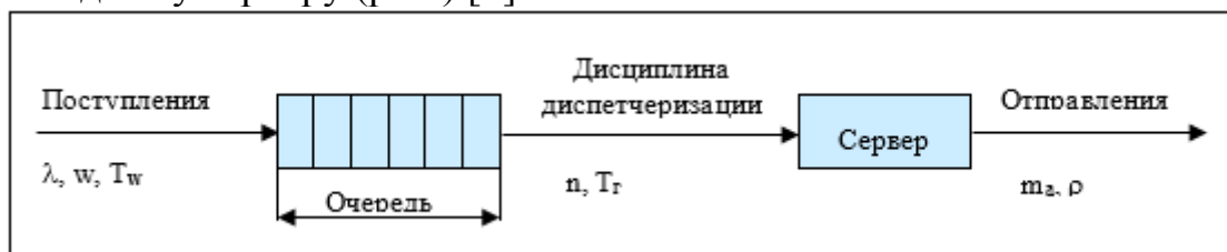
Рис. Структура и параметры системы очередей для очереди с одним сервером где: \lambda – скорость поступления; w – число ожидающих запросов; T_w – время ожидания; n – число запросов в системе с очередью; T_r – время пребывания в системе; m_a – время обслуживания; \rho – коэффициент использования
