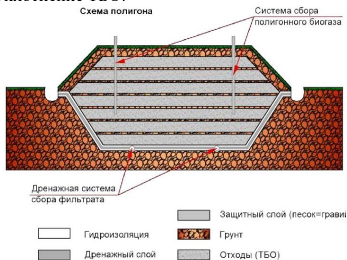
Рис. 2. Устройство полигона и складирования ТБО
