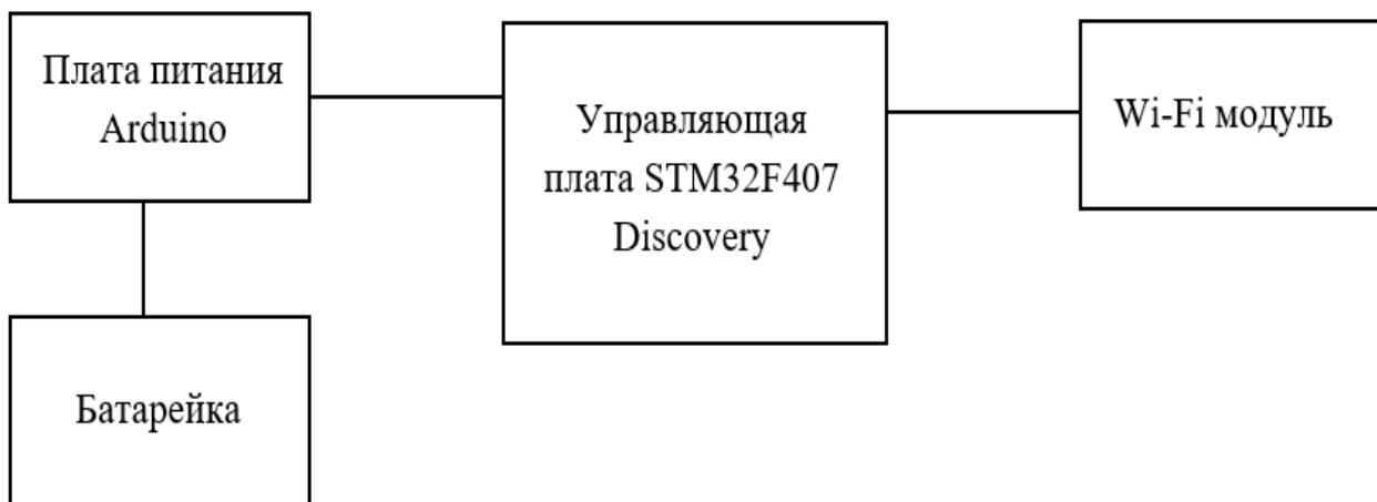
Рис. 5. Структурная схема перчатки управления
