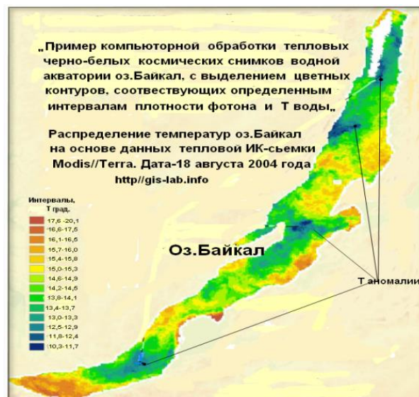
Рис. 48. Пример компьютерной обработки тепловых черно-белых космических снимков водной акватории оз.Байкал, с выделением цветных контуров, соответствующих определенным интервалам фототона и температуры воды (Т). Дата съемки: 18августа 2004 года. http://gis-lab.info
