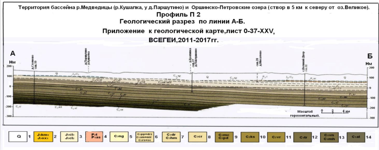
Рис. 33. Профиль П 2 (к рис.30). Геологический разрез по линии А-Б. Приложение к геологической карте, лист О-37-XXV. ВСЕГЕИ, 2011-2017 гг. [3]. Условные обозначения: 1 – четвертичные отложения; 2 – юрские отложения, нижнекиммержидский ярус и нижнеоксфордский подъярус, глины; 3 – верхнекембрийский и среднекембрийский подъярусы, глины; 4 – пермские отложения, татарский и ассельский ярусы, глины, алевроиты; отложения верхнего карбона: 5 – ногинская толща, доломиты; 6 – павлово-посадская и дрезнинская толщи, амаревская и малинниковская толщи, русавкинская и щелковская толщи, известняки мергели, глины; 7 – дорогомилловский и хамовнический горизонты, известняки, глины, мергели; 8 – кривякинский горизонт, известняки, мергели, глины; отложения среднего карбона: 9 – мячковский и подольский горизонты, известняки, доломиты, мергели; 10 – каширский горизонт, известняки, мергели, глины; 11 – верейский горизонт, глины; отложения нижнего карбона: 12 – протвинский, стешевский, тарусский горизонты, известняки, доломиты; 13 – веневский, михайловский горизонты, известняки, глины, алевроиты, пески; 14 – алексинский горизонт, глины, пески
